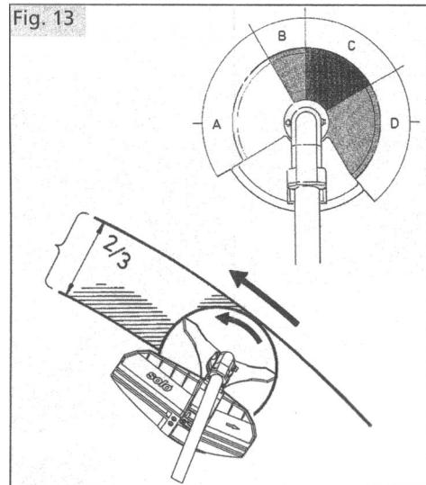
**Внимание:** Для достижения оптимальной производительности мотокосу нужно эксплуатировать на максимальных оборотах и производить резание в рекомендованном направлении.
