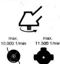
Режущий инструмент должен соответствовать техническим параметрам мотокосы
