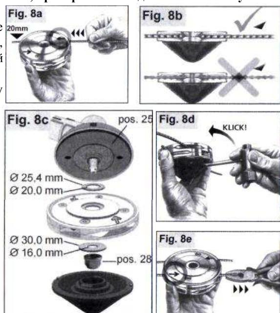
Обратите внимание, что режущий элемент данной катушки нужно выдвигать на определенную длину работы (20мм).
